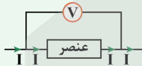
«شکل صحیح بستن ولت‌سنج»
